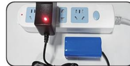
4. Töltse fel az akkumulátort Piros LED: Töltés folyamatban Zöld LED: Töltés kész
